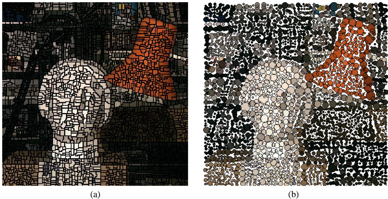
Figura 4.6: Ilustração dos agrupamentos formados após aplicação da watershed : (a) cada região agrupa uma certa quantidade de pixels que determina a sua área A_i , suas fronteiras são determinadas pelas linhas pretas e no interior é representado pela cor média; (b) uma forma mais simplificada de se representar esses elementos que na análise via grafos se tornam vértices, pontos, é os representando por um círculo de área A_i , os cálculos para gradiente e pesos de ligações nos Capítulos futuros, dependerão apenas desses três atributos, posição \vec{r} , cor \vec{I} e área A .
