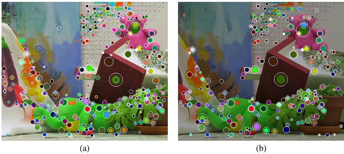
Figura 2.20: Confronto entre duas vistas distintas de uma cena, uma delas submetida a uma transformação na iluminação: (a) vista em seu aspecto original e; (b) vista com magnitude reduzida em \sqrt{2} \times . Os pontos correspondentes entre as duas imagens são marcados por círculos com um mesmo padrão de cor e tamanho. Devido à grande quantidade de pontos, somente são exibidos correspondências com produto interno superior a 0,9.
