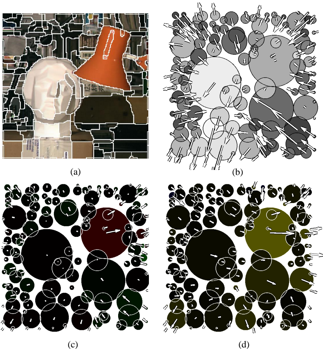
Figura 4.12: Representação em vetores para o gradiente de regiões: (a) a imagem original é dividida em regiões conforme as técnicas de agrupamento definidas neste Capítulo, a simplificação dessas regiões por círculos; (b) podem representar o gradiente para canal de luminância; (c) de oposição das cores verde/vermelho e; (d) de oposição das cores azul/amarelo.
