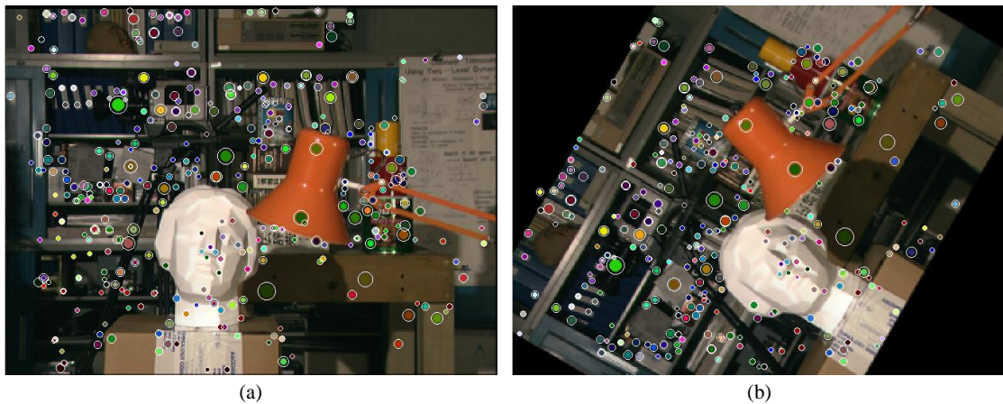
Figura 2.19: Confronto entre duas vistas distintas de uma cena, uma delas submetida a uma rotação: (a) vista em seu aspecto original e; (b) vista rotacionado em 60^\circ no sentido anti-horário. Os pontos correspondentes entre as duas imagens são marcados por círculos com um mesmo padrão de cor e tamanho. Devido à grande quantidade de pontos, somente são exibidos correspondências com produto interno superior a 0,9.
