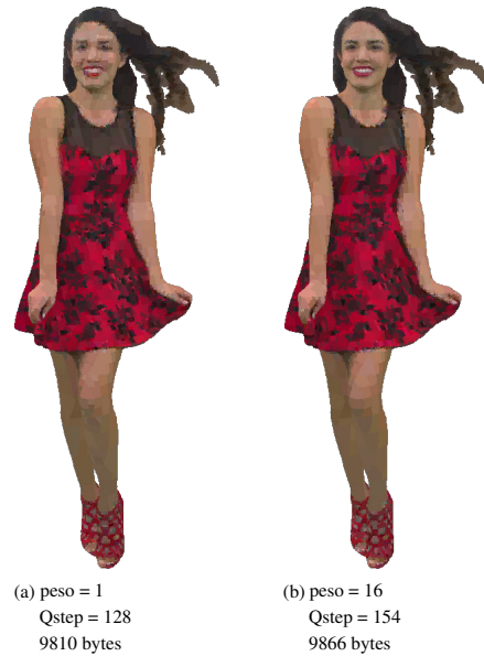
Fig. 5. nuvem de pontos Redandblack ( N_{vox} = 757691 ) codificada com diferentes pesos para voxels na ROI. O Q_{step} foi ajustado para resultar em tamanhos de arquivo semelhantes.
